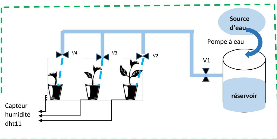
SYSTEME SECONDAIRE ou SITE : Les capteurs, les électrovannes (V1, V2, V3),
